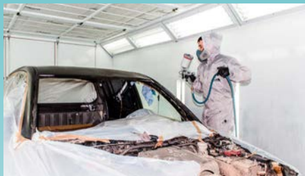
↑ Маляр за работой. Полная покраска в окрасочно-сушильной камере
